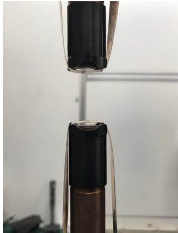
图3 电极带点焊示意
